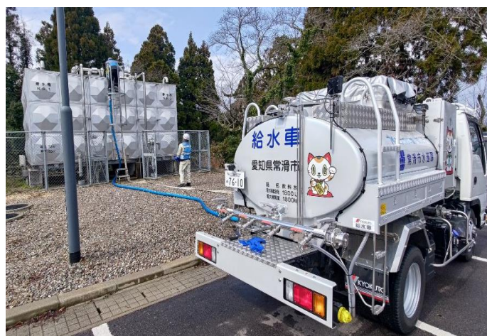
給水車災害支援：石川県の病院・受水槽への加圧給水
