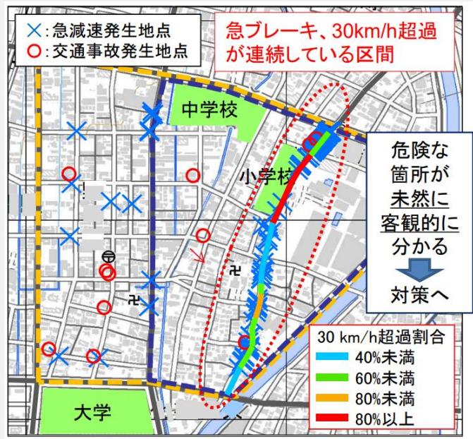
図：交通分野におけるビックデータ活用事例② (ETC2.0を活用した潜在的な危険箇所の把握) 出典:国土交通省
