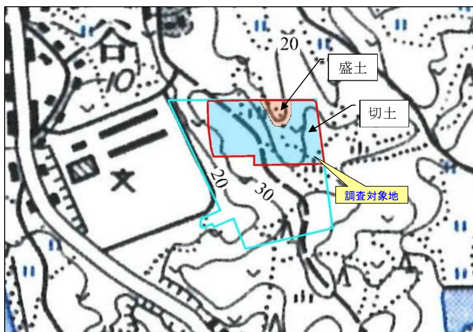
図-4.5 造成に伴う切盛の推定図 (S=1:5,000)
