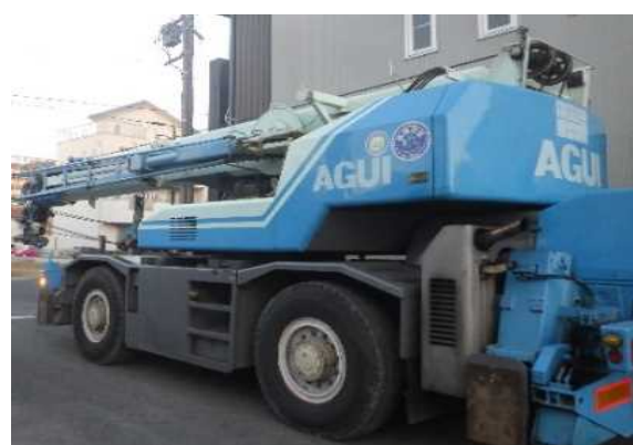
25 t ラフタークレーン
